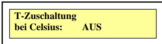
T-Zuschaltung bedeutet, dass der Zirkomat die Pumpe solange einschaltet, bis die Temperatur über den eingegebenen Temperatur-Sollwert ansteigt. Der an der Zirkulationsleitung montierte Anlegefühler (Bestell-Nr. 7000DWT-T) liefert dabei die aktuelle Rohrtemperatur. Um den automatischen Zuschaltmodus einzuschalten ist die Taste „+“ zu betätigen. Die Anzeige springt um auf:
